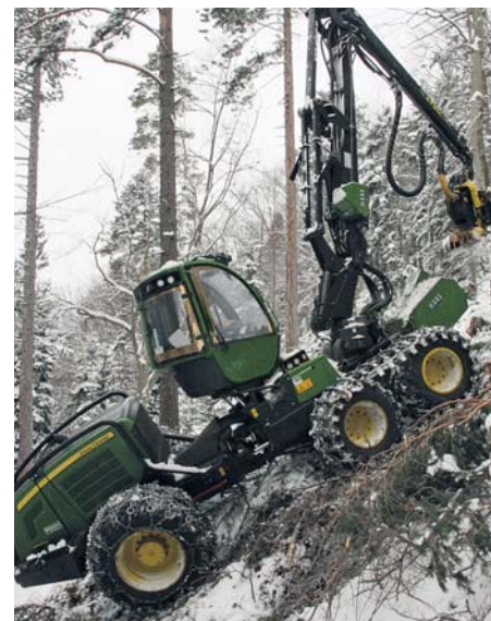
Böschungen können mittels Traktionshilfswinde leichter und mit maximaler Bodenschonung bewältigt werden.
