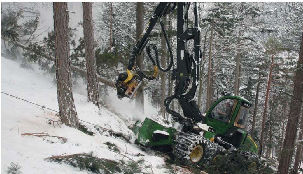
Den John Deere 1170 E lieferte Öforst Forsttechnik mit dem Aggregat H754 und einem 11,7 m-Kran aus – eine Besonderheit ist die Traktionshilfswinde von Haas.
